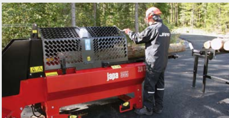
Le vérin de fendage de 7 tonnes permet de fendre facilement les gros diamètres.
