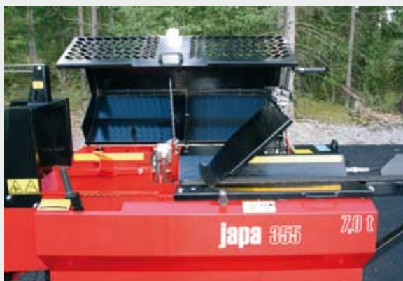
Le carter de sécurité robuste est léger et facile à ouvrir.
