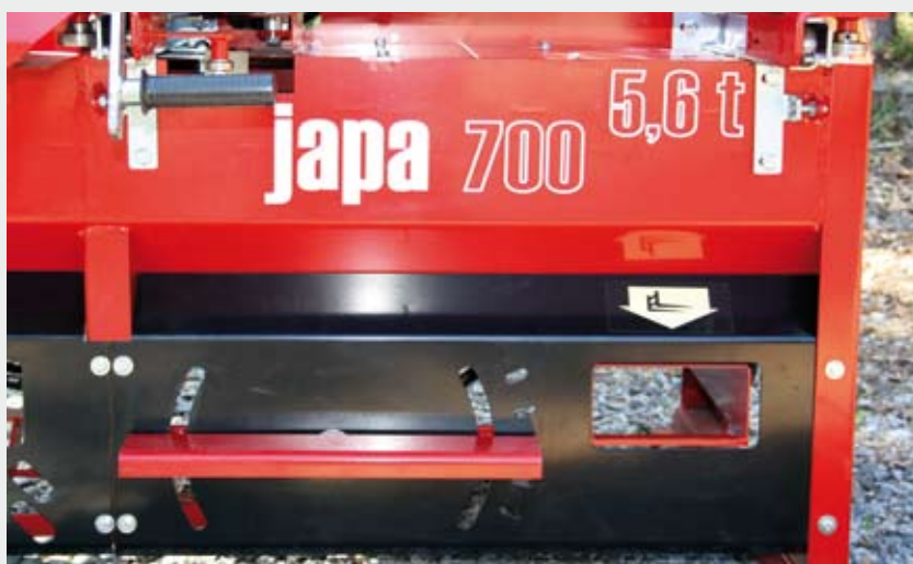
Le coin de fendage s'ajuste à l'aide d'une pédale. Cette fonctionnalité facilite le réglage de la position verticale du coin en fonction de la taille des billes.
