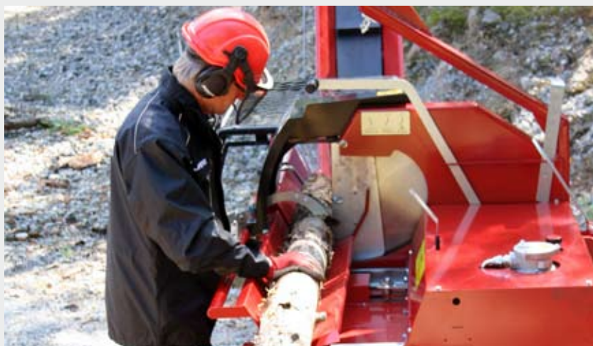
La table d'alimentation se déplace horizontalement et est équipée de roulements à billes. L'utilisation du combiné JAPA 700 ne nécessite ainsi virtuellement aucun effort.
